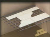
استخدام الألواح الإسمنتية في تغطية أرضيات السقيفة
